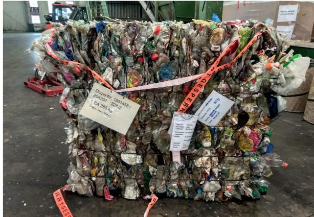
Ballen der Spezifikation Misch-PET 70/30: Bei der Werkstoff-Analyse wurde das Sammelgut in die Fraktionen formstabile PET-Verpackungen, Schalen mit und ohne Peelingfolie und Blister unterteilt
